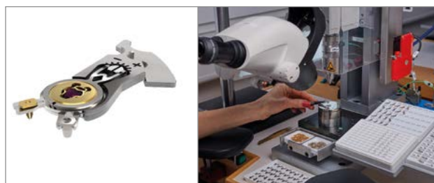
A gauche, une raquetterie et à droite, l'opération d'assemblage d'une raquetterie sur un coq de balancier
